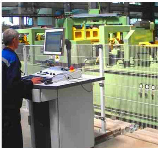
Линия «Georg» TBA600 (Германия) для изготовления сердечников распределительных и силовых трансформаторов
