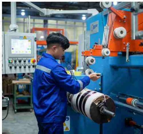
Изготовление обмоток из провода и фольги на намоточных станках с ЧПУ компаний BF и L.A.E. (Италия)
