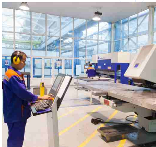
Координатно-пробивной пресс Trumph .Punch-1000 компании TRUMPF (Германия) с ЧПУ для изготовления деталей из листового металла толщиной до 4 мм
